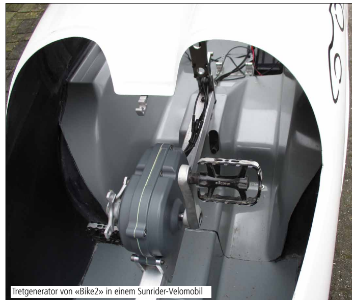
Tretgenerator von «Bike2» in einem Sunrider-Velomobil
